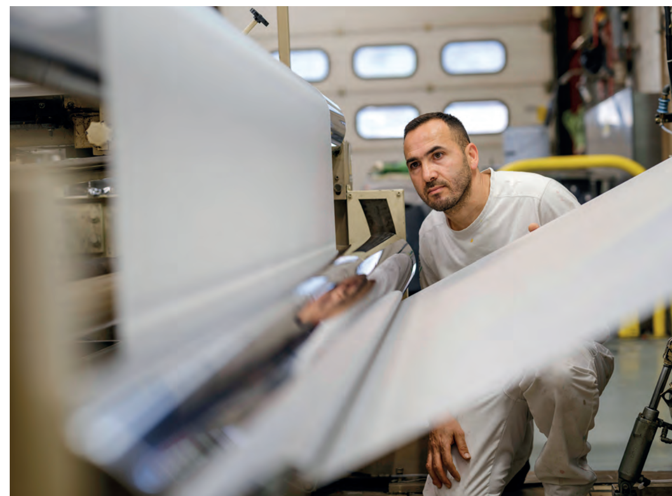
Contrôle de surface des rouleaux de toiles ■ La Tour du Pin
